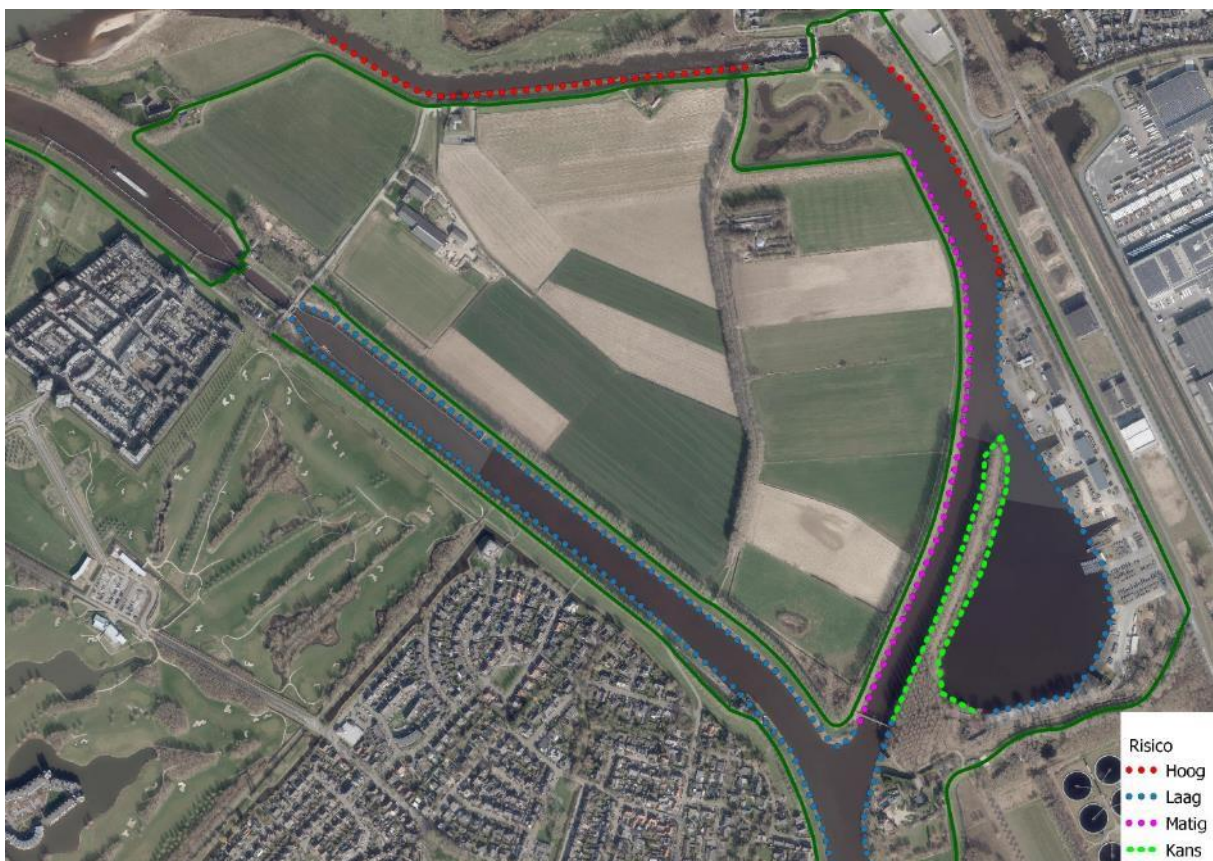
Figuur 3.15: Kansen en risico's in relatie tot de kering (donkergroene lijn) en infrastructuur binnen en rondom de twee territoria van de bever in het noordelijke deel van de Dieze.
