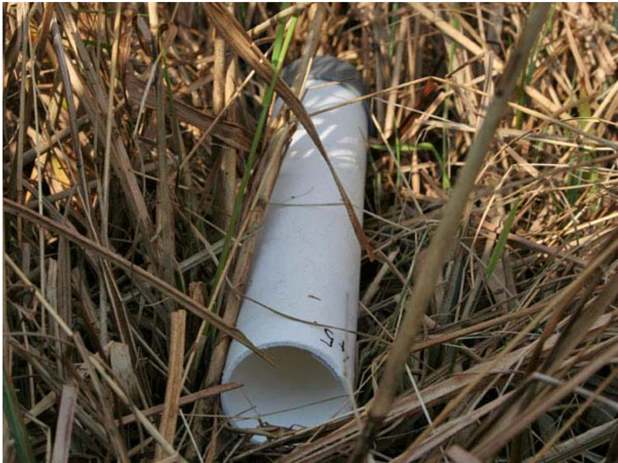
Figuur 8: Lokbuis, ontworpen om uitwerpselen van muizen te verzamelen.
