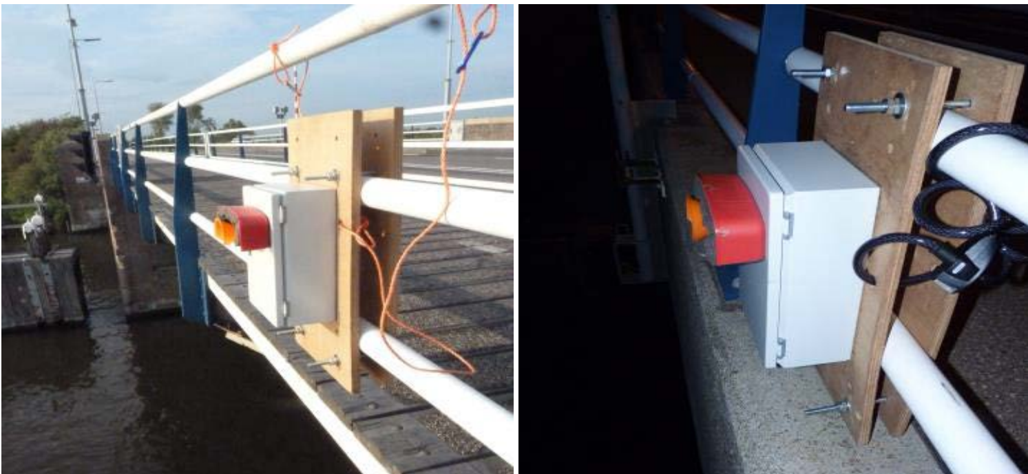
Figuur 13: Bevestiging aan de brugleuning
