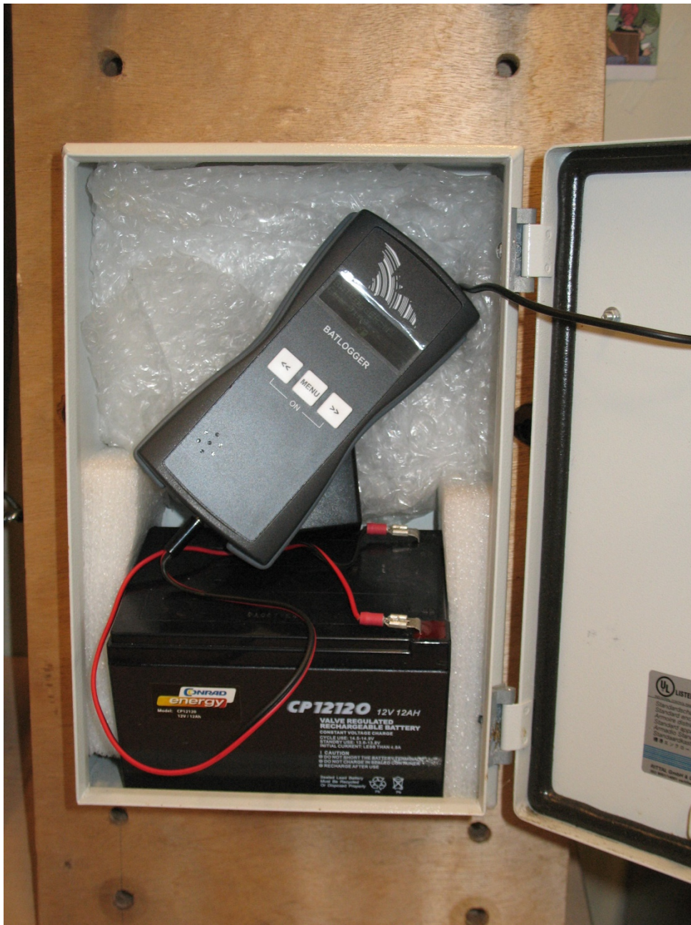
Figuur 12: Constructie van de Batlogger in de waterdichte kist.
