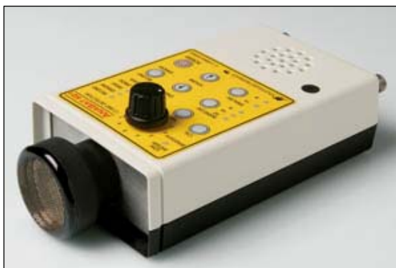
Afbeelding 2. Een AnaBat SD1 CF Bat Detector. Deze detector registreert automatisch de sonargeluiden van passerende vleermuizen.
