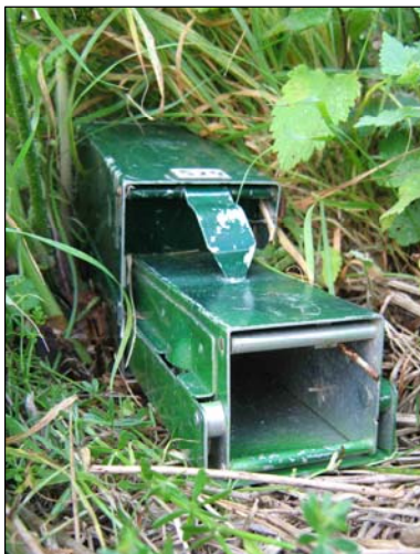
Afbeelding 4. Inloopval van het type Longworth. Foto: R.M. Koelman.
