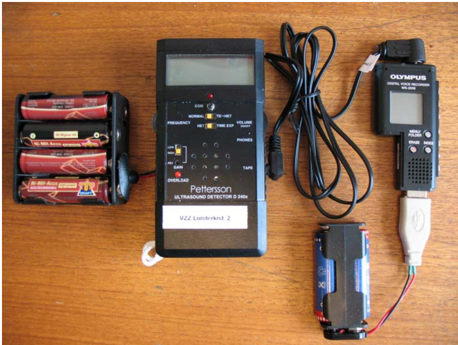
Figuur 1. De inhoud van een VZZ-luisterkist: van links naar rechts accu's, D240x batdetector, tweede accu-set en voicerecorder. Het geheel wordt verpakt in een spatwaterdichte container.
