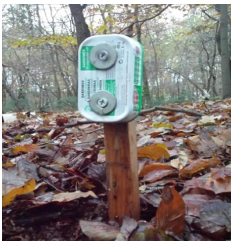
Figuur 1. Het blikje sardines vastgeschroefd op een paaltje. De O-ringen zorgen ervoor dat het blikje niet gemakkelijk over de schroefkoppen heen wordt getrokken.
