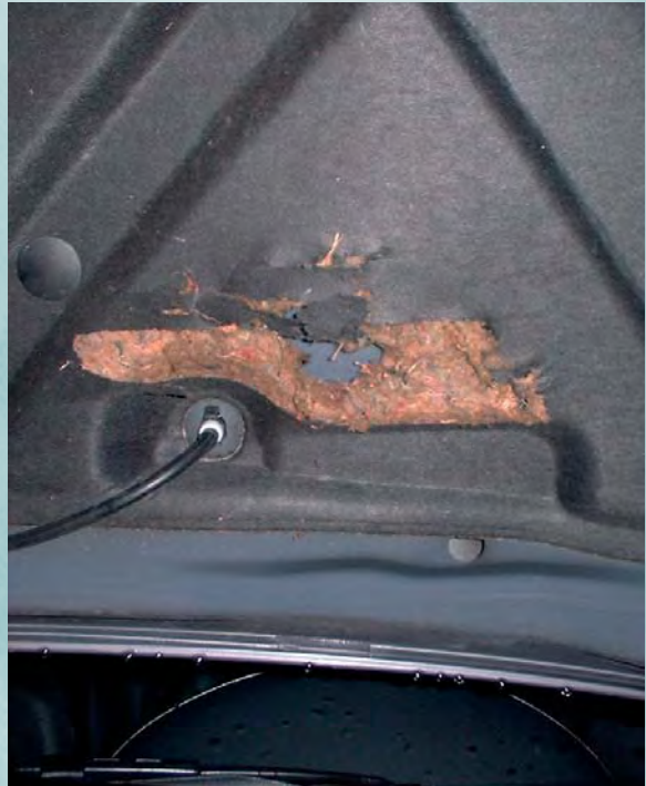
Hier is de isolatie van de motorkap beschadigd door een steenmarter
