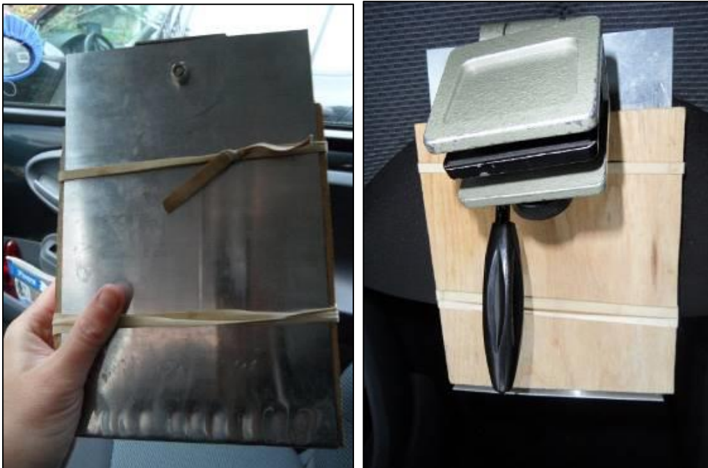
Figuur 6. Links: bovenzijde van houder (bij de meeste houders zit het stuk metaal echter aan de onderzijde). Rechts: ronde, zwarte hendel aan scharnier aan de onderkant van de houder. Mocht je een ander type houder hebben, en niet weten hoe deze werkt, stuur gerust een mailtje naar: nemvtt@zoogdierverseniging.nl
