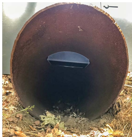
▲ Afbeelding 4. De 3D-geprinte behuizing heeft dezelfde ronding als de faunatunnel, zodat deze naadloos kan worden aangebracht. Foto Mark van Heukelum
