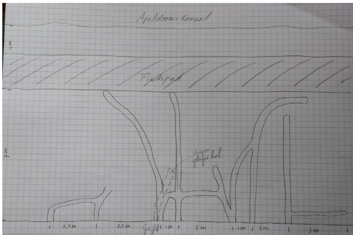
Figuur 2. Overzicht van het holencomplex in de waterkering tussen het Apeldoorns Kanaal en de Grift, ter hoogte van de Vemderweg bij Epe.
