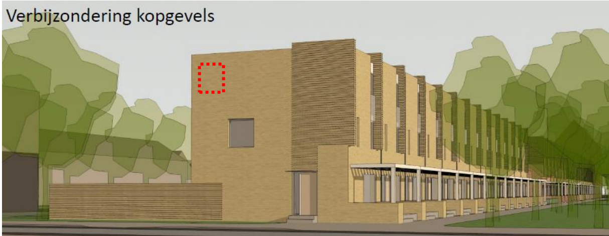
Figuur 5. Voorbeelden van plekken waar kasten kunnen worden ingebouwd (zie rode stippellijnen). Hierbij is rekening gehouden dat er geen obstakels onder de verblijfplaatsen aanwezig zijn en dat de kasten bij voorkeur niet boven ramen of deuren hangen. Bron: Wurck architectuur, bewerking: Zoogdierverseniging.
