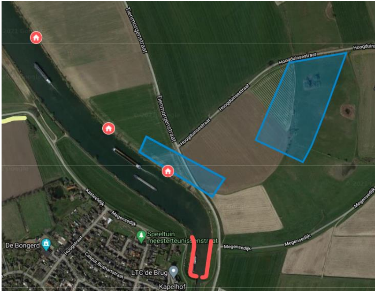
Figuur 3.6. Ligging van beverburchten langs het Burgemeester Delen Kanaal (rode stippen met wit huis) en de ligging van relatief hooggelegen gebieden waar HWVP's gerealiseerd kunnen worden (blauw gearceerd). De rode lijnen geven locaties waar grote risico's zijn voor graafschade bij normale waterstanden.
