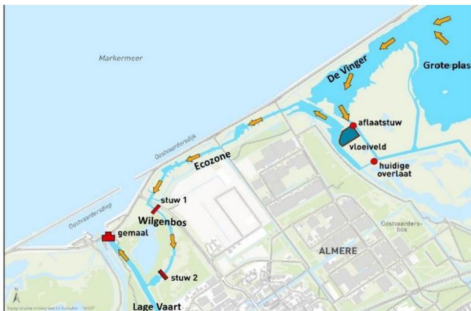
Figuur 9: Route van af te laten water vanuit de OVP naar het Markermeer. Uit Hazelhorst et al. 2018
