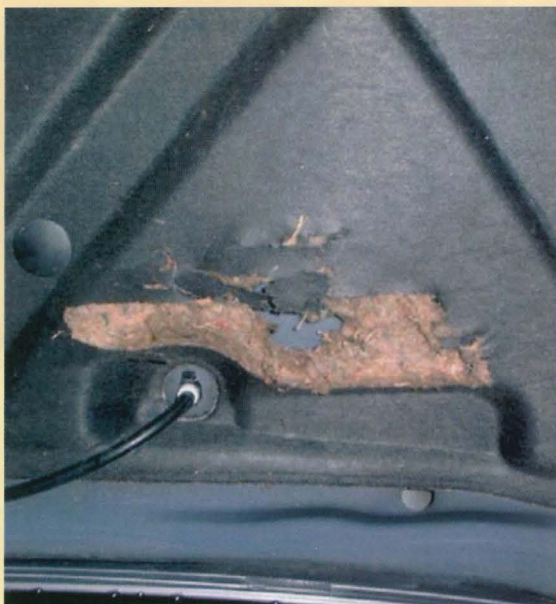
Hier is de isolatie van de motorkap beschadigd door een steenmarter
